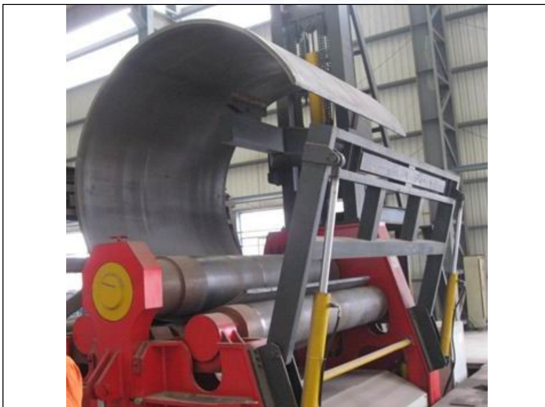
دستگاه رولینگ ورق فولادی با فشار کاری 250 bar
