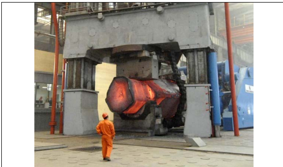
پرس هیدرولیک با فشار کاری 350bar جهت تامین نیروهای بسیار زیاد در صنعت فولاد
